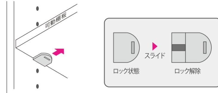
② 可動棚板用ダボピンをお好みの位置に移動させしっかりと差し込み、再度棚を取り付けます。
