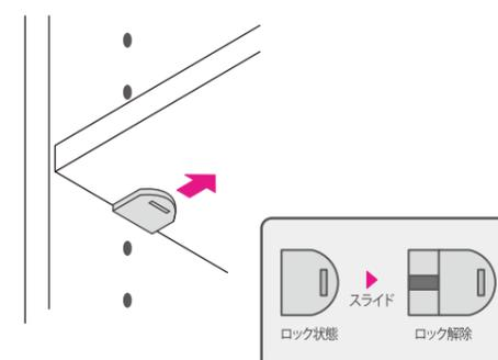
② 可動棚板用ダボピンをお好みの位置に移動させしっかりと差し込み、再度棚を取り付けます。
